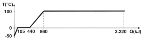
Nos estágios de fusão e de vaporização registrados no gráfico, quais são, respectivamente, o calor latente de fusão do gelo e o calor latente de vaporização da água, expressos em J/g?
