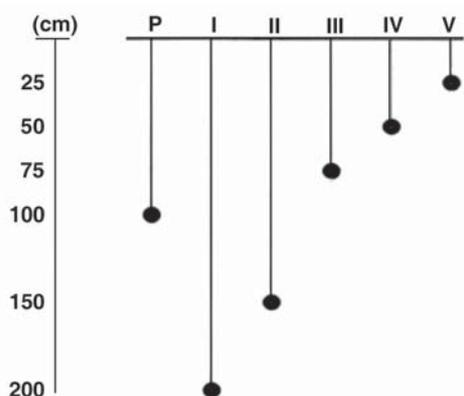
O pêndulo **P** executa uma oscilação completa em 2 s. Qual dos outros pêndulos executa uma oscilação completa em 1 s ?
