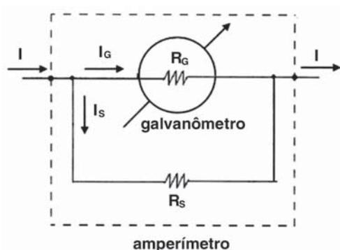
Constrói-se um amperímetro a partir de um galvanômetro, ligando-se a resistência interna  $R_G$  do galvanômetro em paralelo com uma resistência  $R_S$ , chamada de *shunt* (palavra inglesa que significa desvio). Assim, para se obter um amperímetro cuja "corrente de fundo de escala" seja 10 vezes maior do que a do galvanômetro usado, ..... da corrente elétrica  $I$  deverá passar pelo galvanômetro, e o valor de  $R_S$  deverá ser ..... do que o valor de  $R_G$ .
