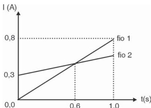
No intervalo de tempo entre zero e 0,6 s, a quantidade de carga elétrica que atravessa uma seção transversal do fio é maior para o fio ..... do que para o outro fio; no intervalo entre 0,6 s e 1,0 s, ela é maior para o fio ..... do que para o outro fio; e no intervalo entre zero e 1,0 s, ela é maior para o fio ..... do que para o outro fio.
