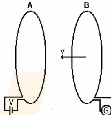
Esta figura representa dois circuitos, cada um contendo uma espira de resistência elétrica não nula. O circuito A está em repouso e é alimentado por uma fonte de tensão constante  $V$ . O circuito B aproxima-se com velocidade constante de módulo  $v$ , mantendo-se paralelos os planos das espiras. Durante a aproximação, uma força eletromotriz (f.e.m.) induzida aparece na espira do circuito B, gerando uma corrente elétrica que é medida pelo galvanômetro G.
