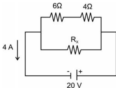
No circuito, por onde passa uma corrente elétrica de 4 A, três resistores estão conectados a uma fonte ideal de força eletromotriz de 20 V.
