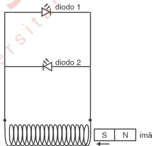
Os diodos foram ligados em oposição um ao outro, de modo que, quando a corrente elétrica passa por um deles, não passa pelo outro. Um ímã em forma de barra é movimentado rapidamente para dentro ou para fora do solenóide, sempre pelo lado direito do mesmo, como também está indicado na figura.
