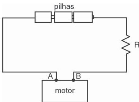
A tensão entre os terminais A e B do motor é 4,0 V. Qual é a potência elétrica consumida pelo motor?
