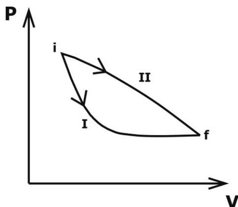
A figura mostra dois processos, I e II, em um diagrama pressão (P) x volume (V) ao longo dos quais um gás ideal pode ser levado do estado inicial i para o estado final f.
