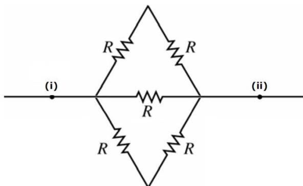
Considerando que todos os cinco resistores têm resistência elétrica  $R$ , a potência total por eles dissipada é
